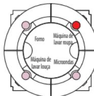
Após uma sobrecarga de tensão a central desactiva a carga com prioridade 1.
