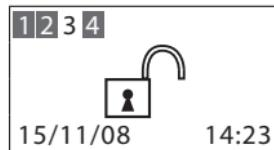
Installation branchée, signal d'alarme intrusion
