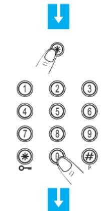
Taper le code utilisateur (de base 00000) ou un code numérique valable; en tapant un code erroné, au bout de la troisième tentative, le clavier se bloque pendant 1 minute environ
