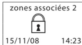
Installation débranchée, batterie de la Centrale déchargée ou défectueuse
