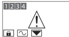
Installation débranchée, batterie du système antivol déchargée ou défectueuse et signal d'alarme technique
