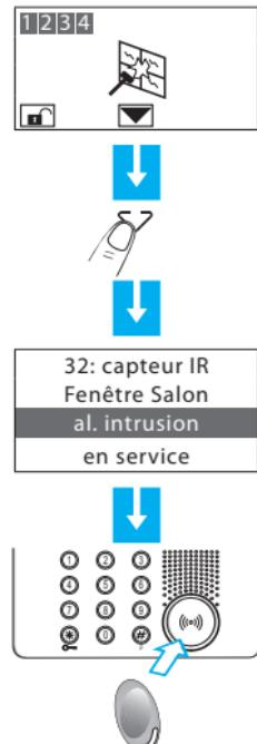
Dans le cas d'alarme technique (le symbole correspondant apparaît), on peut connaître le dispositif qui a généré l'alarme et aussi le remettre à zéro
